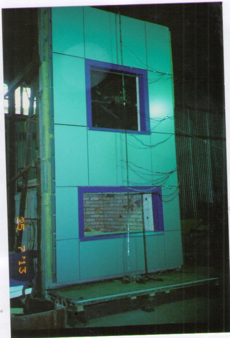
Рис.5.1. Общий вид перед испытаниями по ГОСТ 31251-2008 образца навесной фасадной системы «Альт-Фасад-06» (далее по тексту сокращенно – «образца фасадной системы»), смонтированного на фрагменте железобетонной стены. Облицовка откосов оконных проемов - панели и кассеты из алюминиевых композитных панелей «Alcotek FR Plus» (далее по тексту сокращенно – «панели/кассеты из «Alcotek FR Plus»»), облицовка основной (фронтальной) поверхности образца – кассеты из алюминиевых композитных «Alcotek FR» (далее по тексту сокращенно – «кассеты из «Alcotek FR»).
