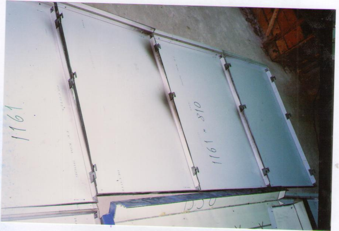
Рис.5.21. Состояние после испытаний панели из «Alcotek FR Plus», выполнявшей функцию накладной облицовки верхнего откоса (критериальный уровень №2) имитации оконного проема, и кассет из «Alcotek FR» в горизонтальной простенке между верхним откосом имитации оконного проема и верхним торцом образца. Вид панели со стороны лицевой и тыльной поверхности, кассет - со стороны тыльной поверхности. [См. совместно с рис. 5.12].
