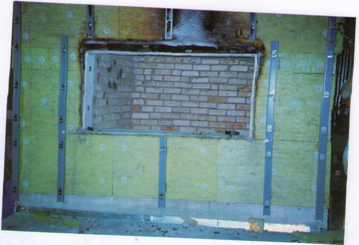
Рис.5.23. Состояние после испытания «подконструкций» и минераловатных плит утеплителя на участках образца фасадной системы между нижним откосом оконного (огневого) проема и нижним торцом образца, по бокам от этого проема. [См. совместно с рис. 5.22].
