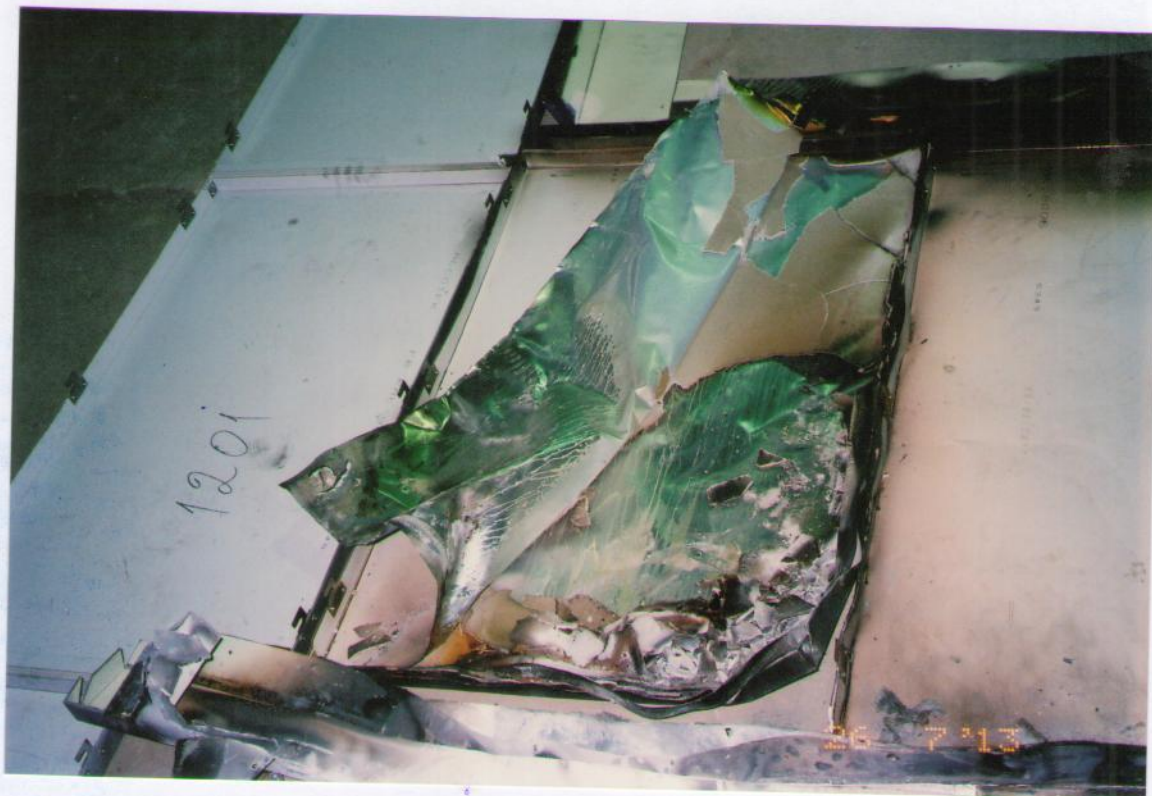
Рис.5.16. Состояние после испытаний материала среднего одной (правой) из двух средних кассет из «Alcotek FR», располагавшихся в горизонтальной простенке между верхним откосом оконного (огневого) проема и нижним откосом имитации оконного проема. Вид кассеты со стороны ее тыльной («необогреваемой») поверхности. Алюминиевая обшивка кассеты специально вскрыта и отогнута после испытаний. [См. совместно с рис. 5.15].
